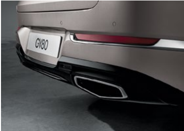
Встроенные в задний бампер патрубки глушителей (для бензиновых двигателей)
